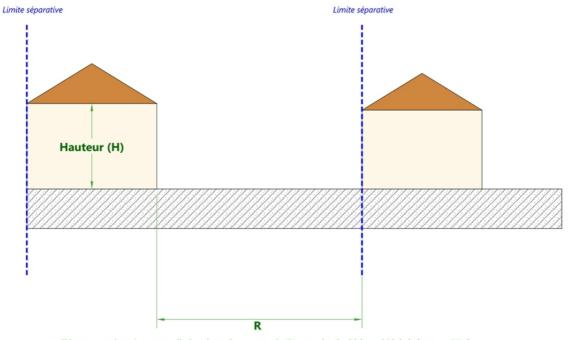
Si la construction n'est pas en limite séparative, un retrait (R) au moins égal à la moitié de la hauteur (H) du bâtiment est nécessaire, avec un minimum de 3 mètres R ≥ H/2 (avec minimum de 3 mètres)
