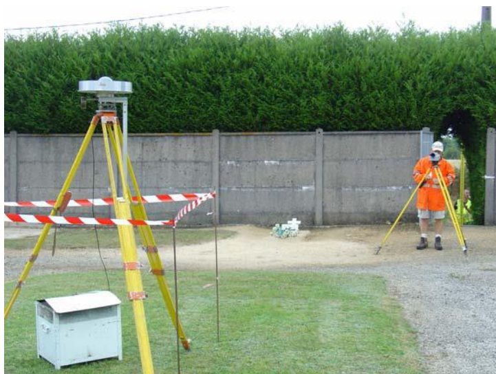
Entretien du réseau de nivellement
